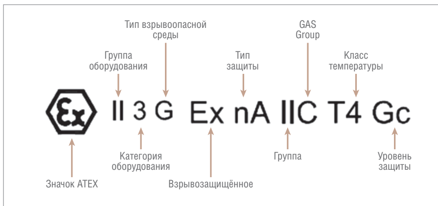
Рис. 5. Пример европейской маркировки взрывозащищённых изделий
