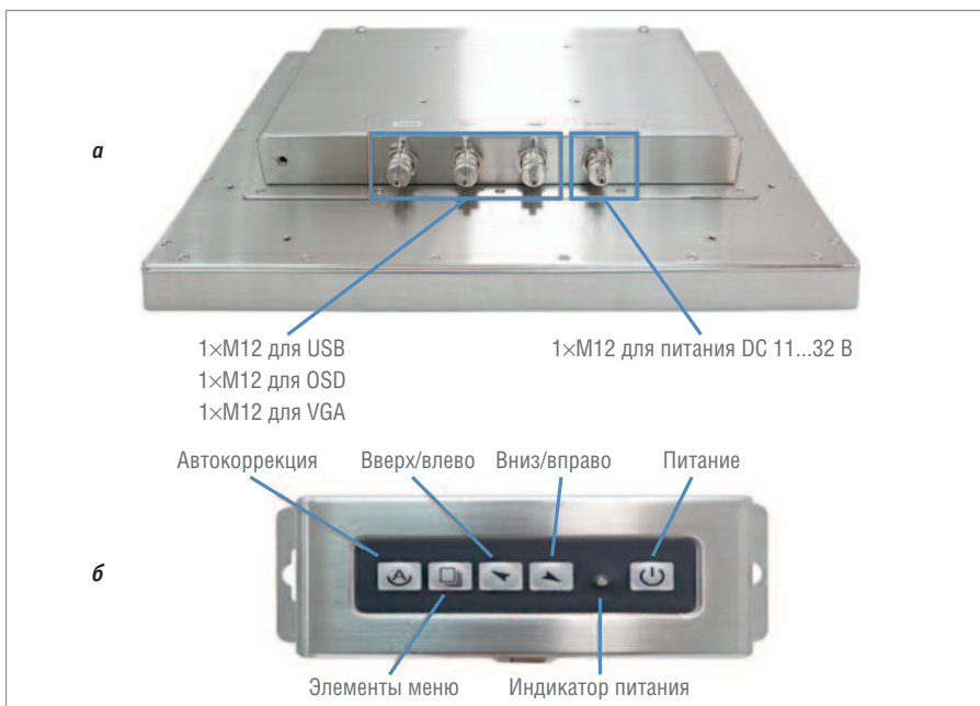
Рис. 9. Вид коннекторов (а) и вынесенного блока OSD (б) взрывозащищённого дисплея серии АЕх
