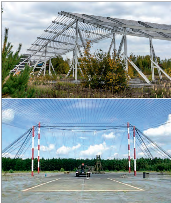
Рис. 4. Двухэлектродные стационарные испытательные стенды, предназначенные для испытания относительно крупных объектов на устойчивость к воздействию ЭМИ ЯВ
