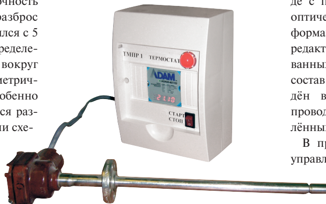
Рис. 6. Внешний вид типового модуля регулирования температуры
