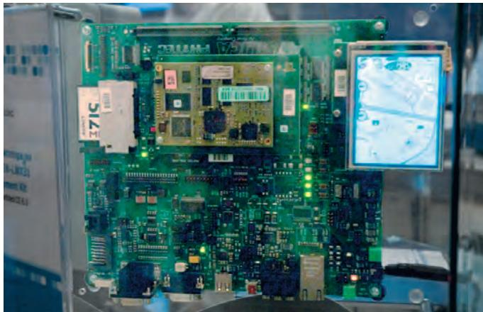
**Рис. 2. Отладочный макет GPS/ГЛОНАСС-навигатора под Windows Embedded, представленный компанией Quarta Technologies**
