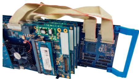
Рис. 35. Модуль Star-Hub для синхронизации четырёх дигитайзеров
