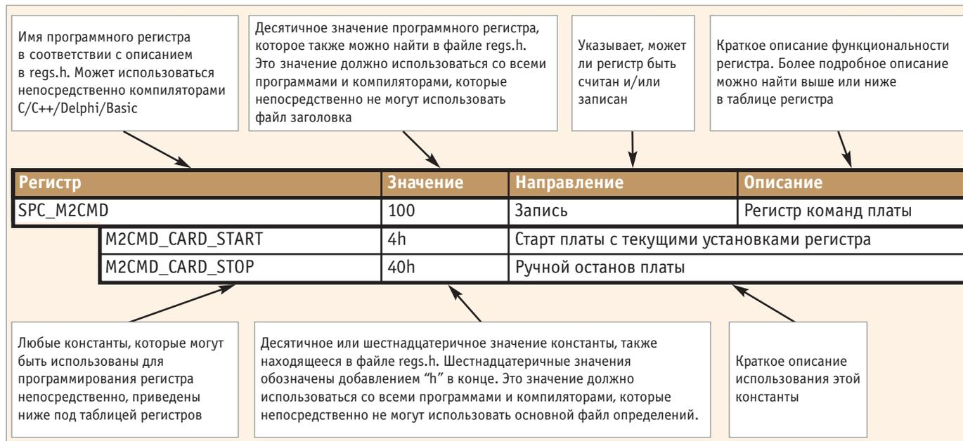
Рис. 40. Программирование дигитайзеров Spectrum полностью основано на работе с виртуальными регистрами
