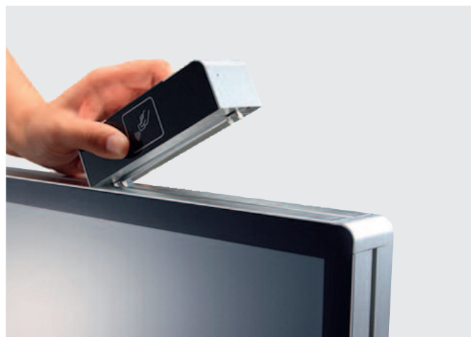
Рис. 4. Установка периферийного оборудования на UTC-750
