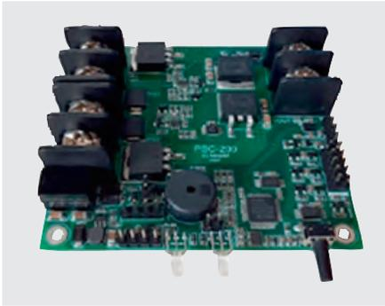
Рис. 5. Плата управления питанием AdvantiX PSC-200
