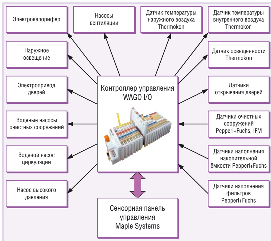
Рис. 2. Структура системы автоматизации мойки
