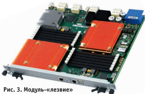
**Рис. 3. Модуль-«лезвие» ATCA-7365 компании Emerson с двумя 6-ядерными процессорами Intel Xeon 5645 2,4 ГГц (микроархитектура Westmere) и 12 слотами для установки памяти DDR3**
