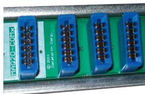
Рис. 7. Объединительная плата на DIN-рейке
