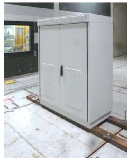
Рис. 11. Модульный шкаф в ветровом туннеле
