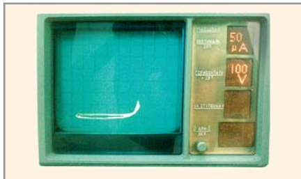
Рис. 4. Обратная характеристика коллектор-база перехода i-GaAs HBT p-n-p типа
