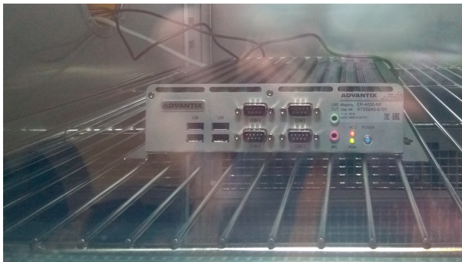
Рис. 1. Климатические испытания промышленного компьютера при -40^{\circ}\text{C}
