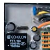
Рис. 13. Модуль ввода-вывода DI6UP с LON-интерфейсом
