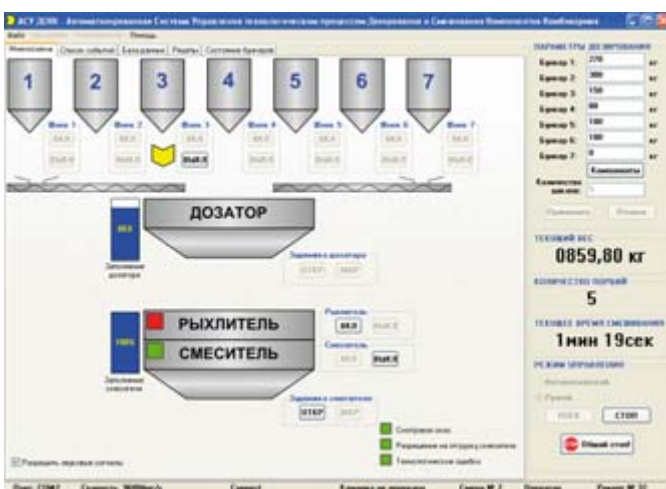
Рис. 7. Мнемосхема в режиме ручного управления
