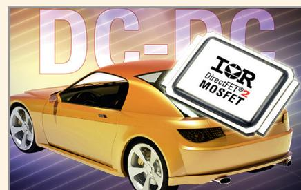
Транзистор MOSFET AU1RL7732S2 с логическим уровнем управления характеризуется низким значением заряда затвора ( $Q_g$ ) и площадью основания на 38% меньшей, чем у корпуса SO-8, что делает их применимыми в понижающих преобразователях с синхронным выпрямлением в качестве выпрями-
