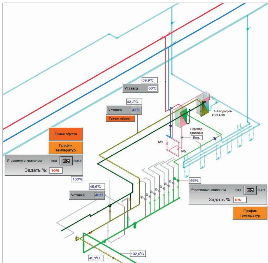
Рис. 3. Фрагмент SCADA – ГВС теплового пункта
