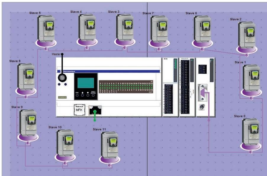
Рис. 4. Структурная схема подключения частотных преобразователей к ПЛК
