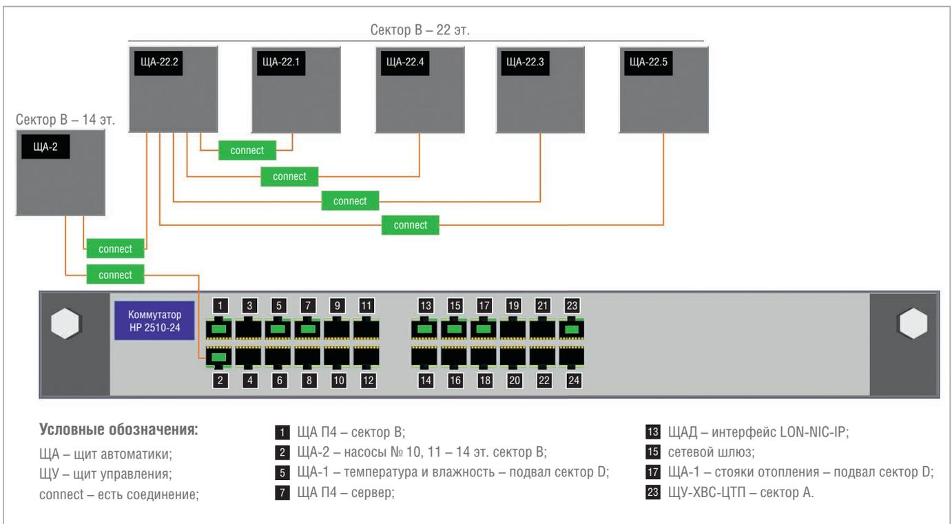
Рис. 7. Фрагмент SCADA – контроль линии связи
