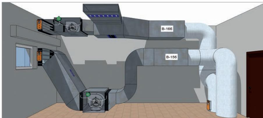
Рис. 8. Фрагмент SCADA – трёхмерное отображение вытяжных систем
