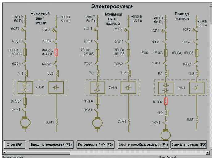
Рис. 4. Видеокادر «Электросхема», выводимый на экран компьютера АРМ
