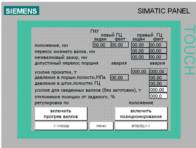
Рис. 3. Видеокادر «Гидромеханическое нажимное устройство» панели оператора
