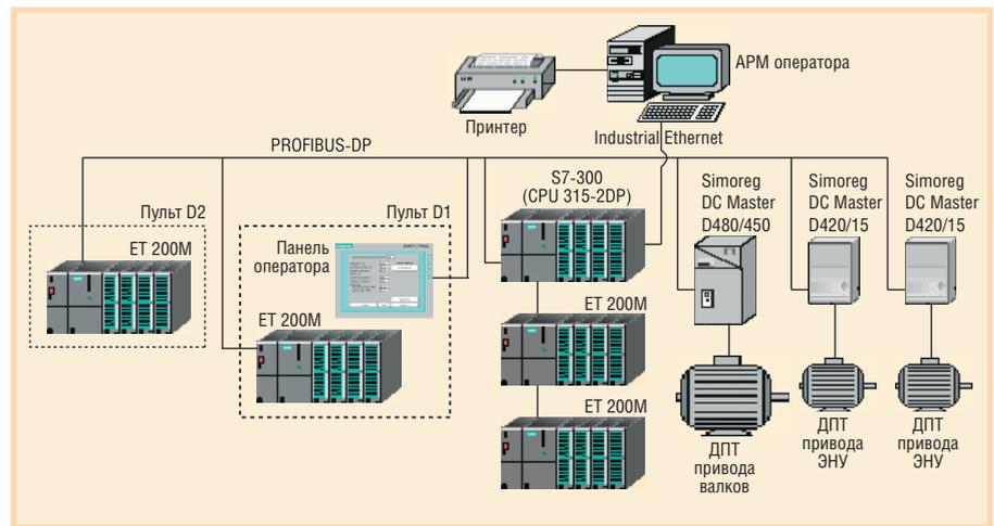
Условные обозначения: ДПТ – двигатель постоянного тока; ЭНУ – электромеханическое нажимное устройство.
