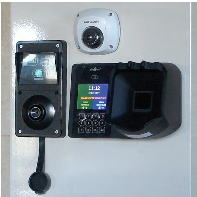
Рис. 3. Интеграция терминала PV-WTC, алкотестера и камеры
