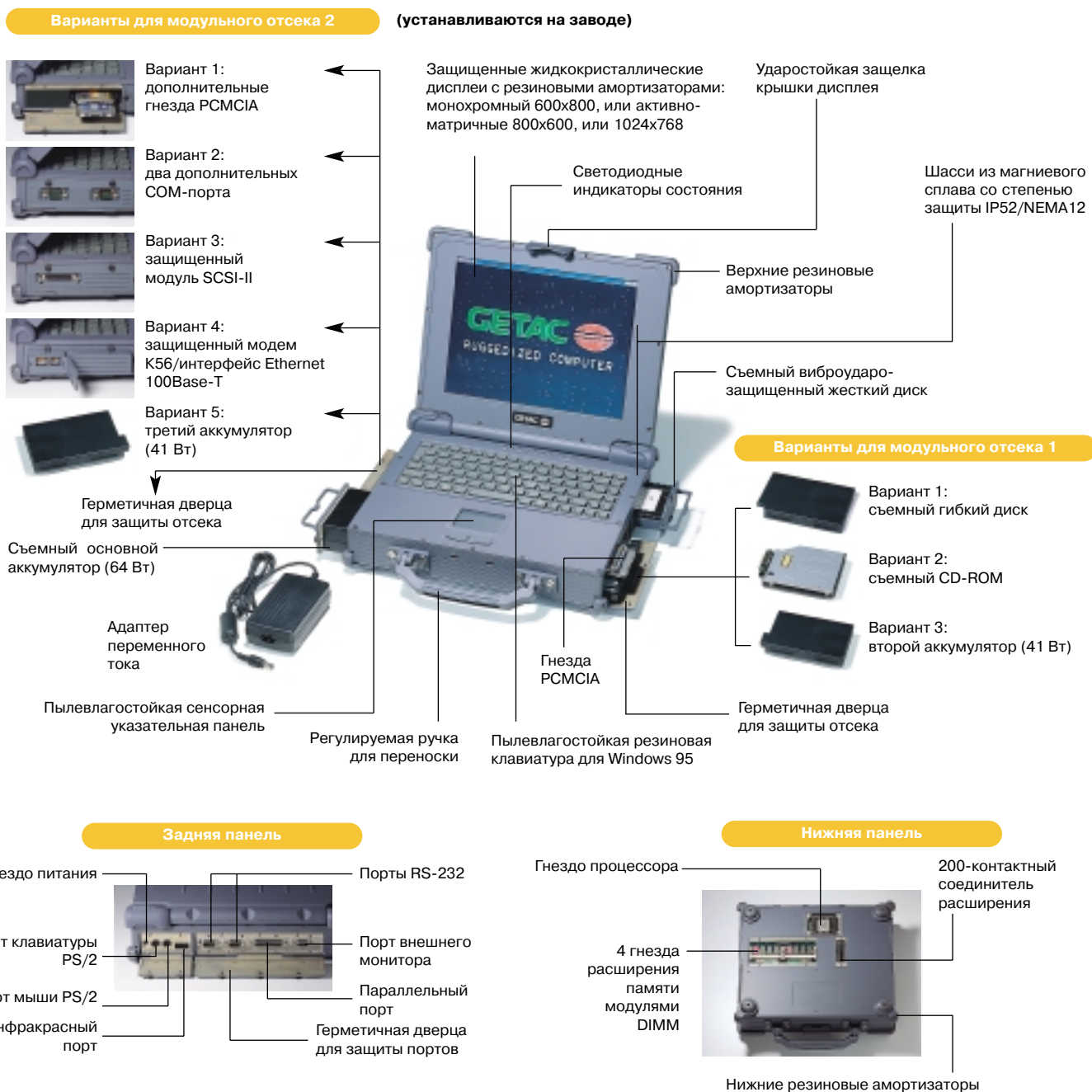
Рис. 3. Возможности расширения конфигурации ноутбука Getac серии А
