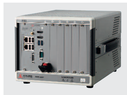
Рис. 4. Гибридное 6-слотовое шасси PXES-2301
