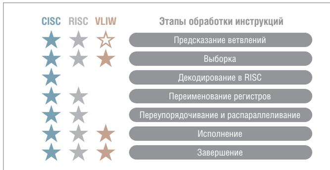
Рис. 7. Сравнение конвейеров
