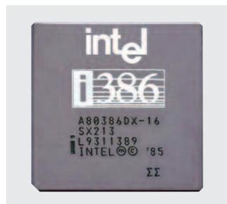
Рис. 2. Первый 32-битный микропроцессор Intel
