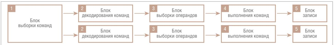
Рис. 4. Двойной конвейер
