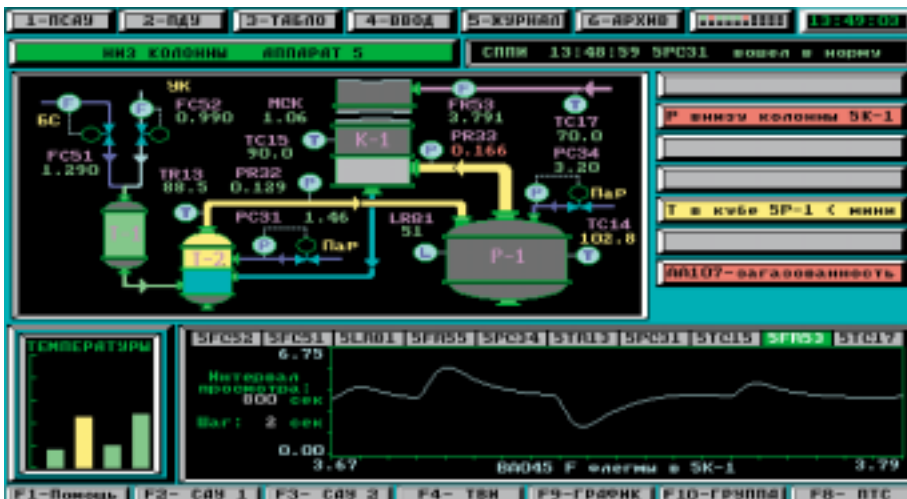
Рис. 3. Пример экранной формы, отображающей различные технологические параметры
