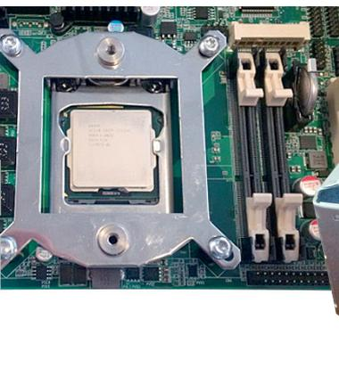
Рис. 11. Крепёжная скоба теплопроводящего модуля FHC высотой 70 мм
