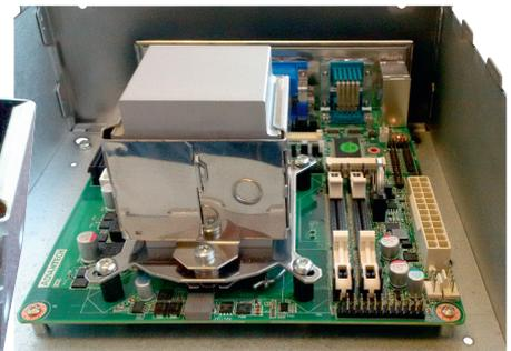
Рис. 13. Установленный на плате теплопроводящий модуль FHC высотой 70 мм
