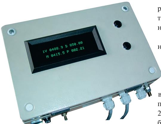
Рис. 2. Блок контроля топлива в базовой комплектации (БКТ 2.2)
