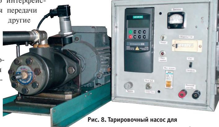
Рис. 8. Тарировочный насос для проведения тарировок топливного бака
