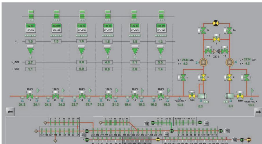
Рис. 2. Мнемосхема линейной части трубопровода Пурпе – Самотлор
