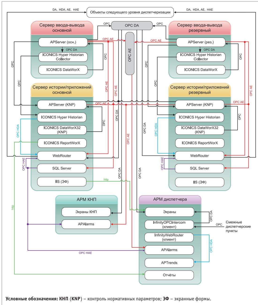
Рис. 1. Структурная схема информационных потоков РДП «Ноябрьск» (нефтепровод Пурпе – Самотлор)
