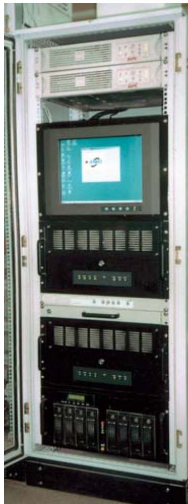
Рис. 6. Шкаф с двумя серверами и массивом дисковых накопителей
