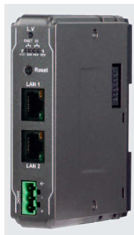
Рис. 5. Коммуникационный модуль iR-ETN (протокол Modbus)
