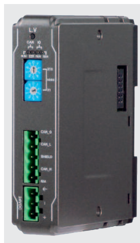
Рис. 4. Коммуникационный модуль iR-COP (протокол CAN Bus)
