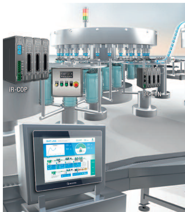
Рис. 1. Панель оператора сMT3090 + CODESYS + модуль ввода/вывода iR
