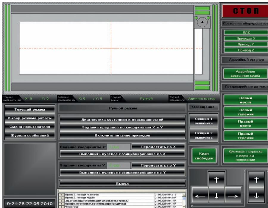
Рис. 5. Окно управляющей программы пульта оператора в ручном режиме
