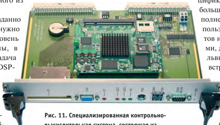
Рис. 11. Специализированная контрольно-вычислительная система, состоящая из платы-носителя и КМ ETX FASTWEL CPB904
