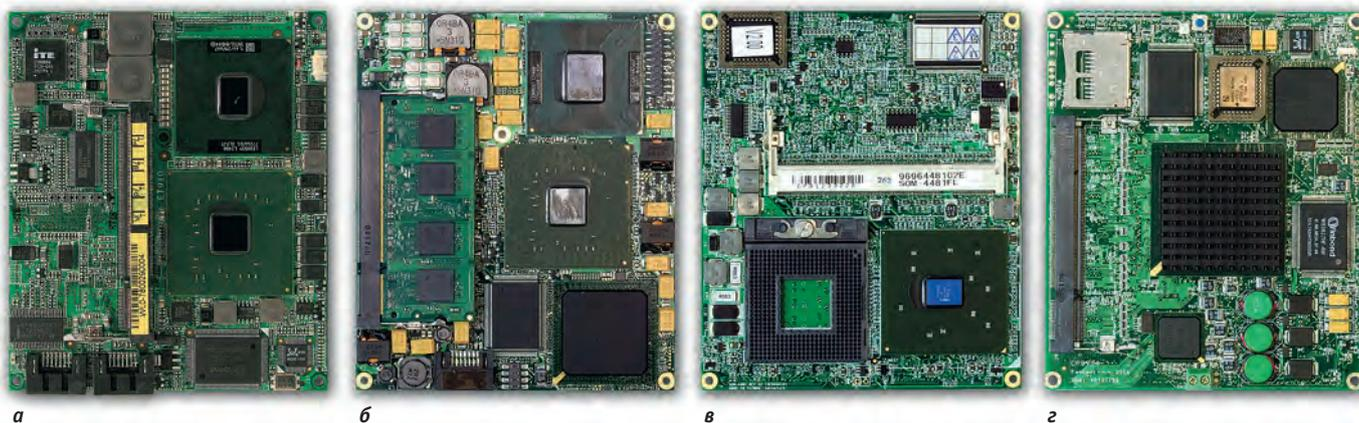
Рис. 7. Примеры KM ETX, производимых различными компаниями:
