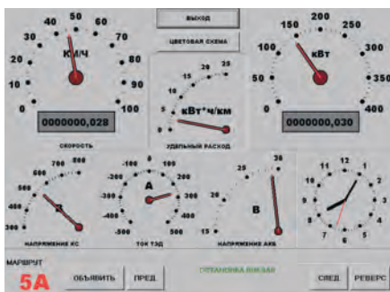
Рис. 4. Виртуальная панель приборов, отображаемая на экране компьютера
