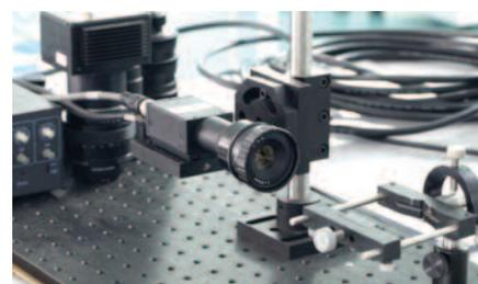
Рис. 3. Промышленная видеокамера высокого разрешения
