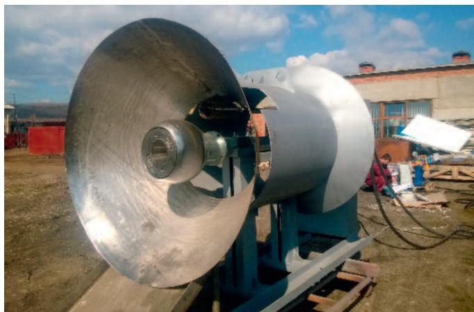
Рис. 1. Макет горелочной установки и её практическая реализация
