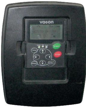
Рис. 3. Панель оператора преобразователя частоты
