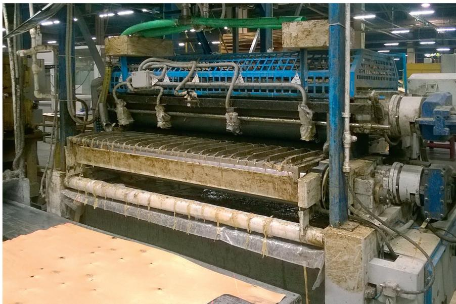
Рис. 1. Клеенаносящий станок OSAMA SV4-350-1800
