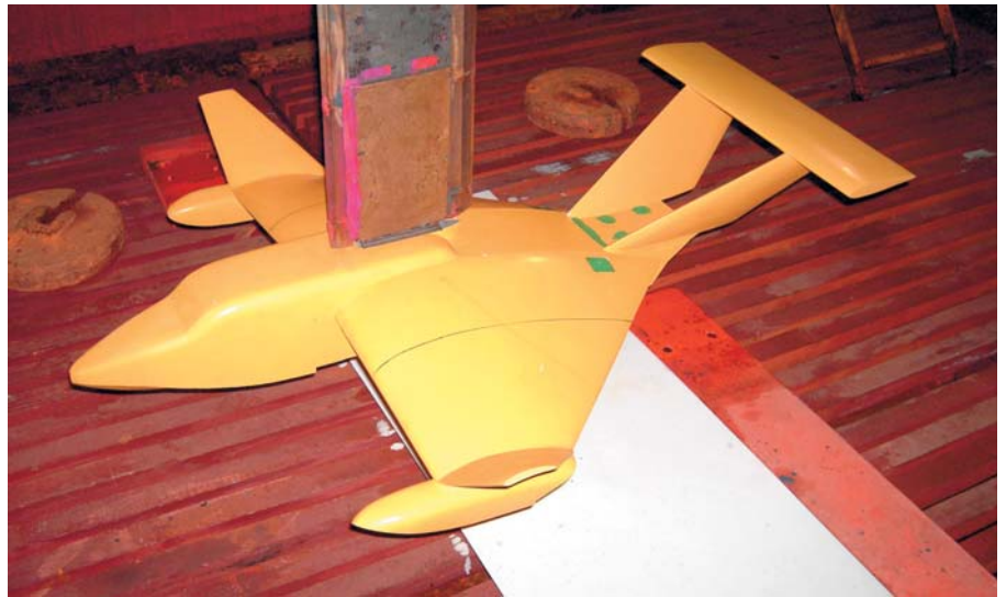
Рис. 3. Модель экраноплана в опытном бассейне
