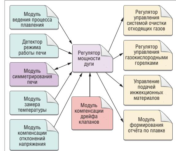
Рис. 2. Блок-схема комплекса управления
