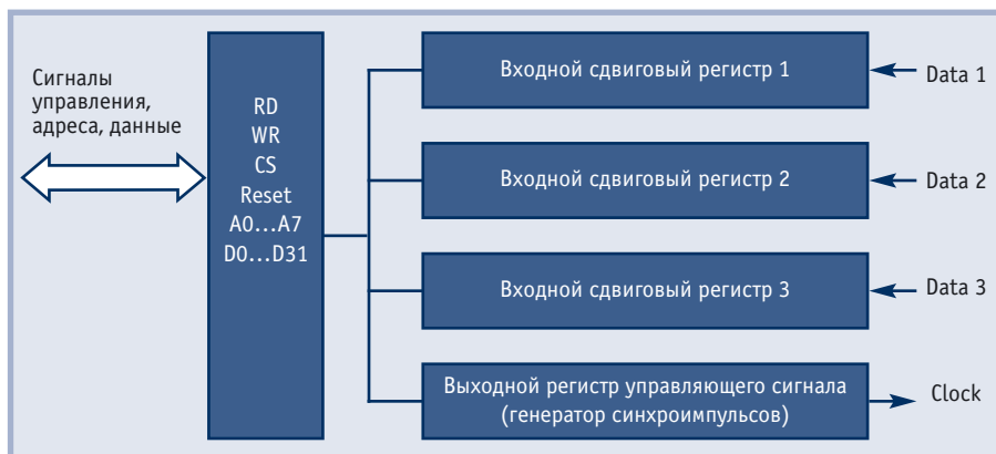
Рис. 5. Функциональная схема интерфейсного модуля платы APCI-1710
