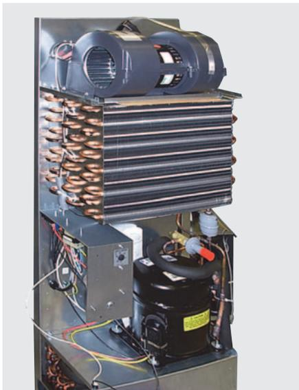
Рис. 12. Конструкция холодильного агрегата
