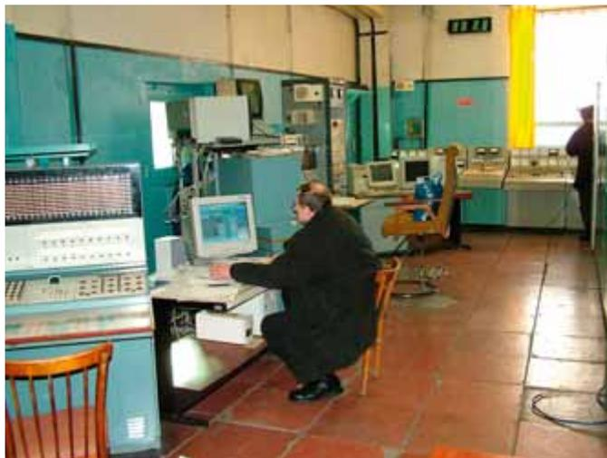
Рис. 5. Пульты огня испытательных стендов НИИМаш
