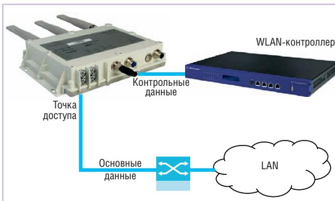
Рис. 1. Структура WLAN-контроллера
