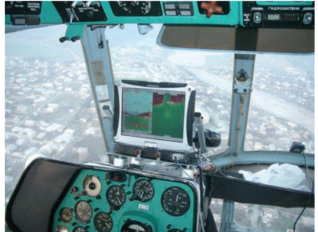
Рис. 4. Ноутбук CF-19 в составе комплекта ПНС-А, установленного в вертолёте МИ-8
