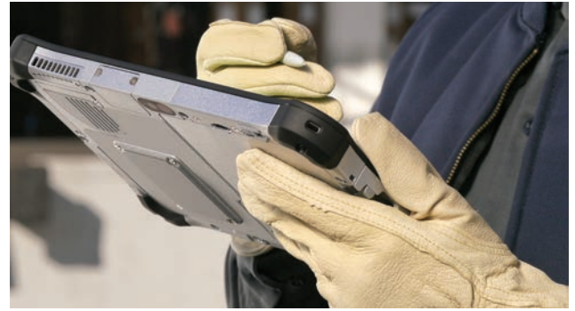
Рис. 2. Планшет FZ-G1 позволяет работать в перчатках
