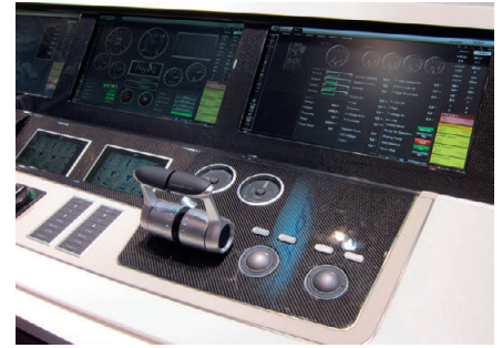
Рис. 3. 38-миллиметровый водонепроницаемый трекбол в рулевой рубке
