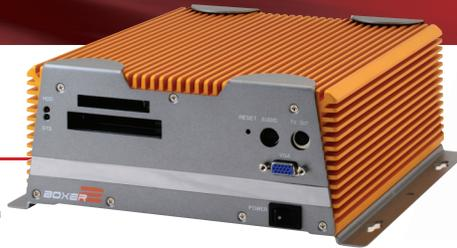
Расширяемый безвентиляторный встраиваемый компьютер, процессор Intel® Core™ 2 Duo, слот расширения PCI-Express
