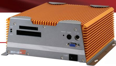
Расширяемый безвентиляторный встраиваемый компьютер, процессор Intel® Core™ 2 Duo, слот расширения PCI-Express
