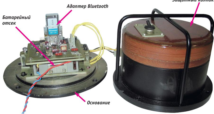
Рис. 5. Конструкция измерительного блока
