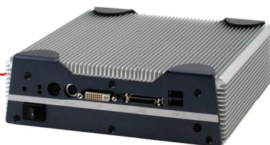
Компактный безвентиляторный мультимедийный компьютер, процессор Intel® Core™ 2 Duo
