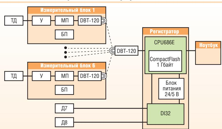
Условные обозначения: ТД — тензометрический датчик; У — усилитель; МП — микропроцессор с аналогово-цифровым преобразователем; БП — батарея питания; DBT-120 — радиоадаптер Bluetooth; Д7 — датчик скорости вращения коленвала дизеля; Д8 — датчик скорости автомобиля; CPU686E — центральный процессорный блок; DI32 — модуль ввода дискретных сигналов.
