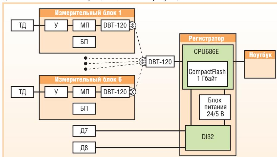
Условные обозначения: ТД — тензометрический датчик; У — усилитель; МП — микропроцессор с аналого-цифровым преобразователем; БП — батарея питания; DBT-120 — радиоадаптер Bluetooth; Д7 — датчик скорости вращения коленвала дизеля; Д8 — датчик скорости автомобиля; CPU686E — центральный процессорный блок; DI32 — модуль ввода дискретных сигналов.
