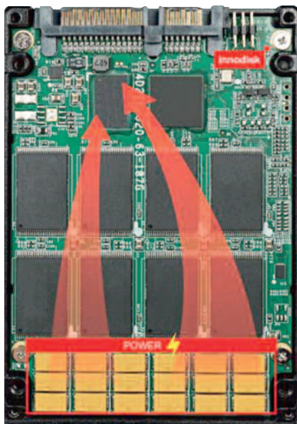
Рис. 2. Твердотельный диск со встроенной батареей конденсаторов
