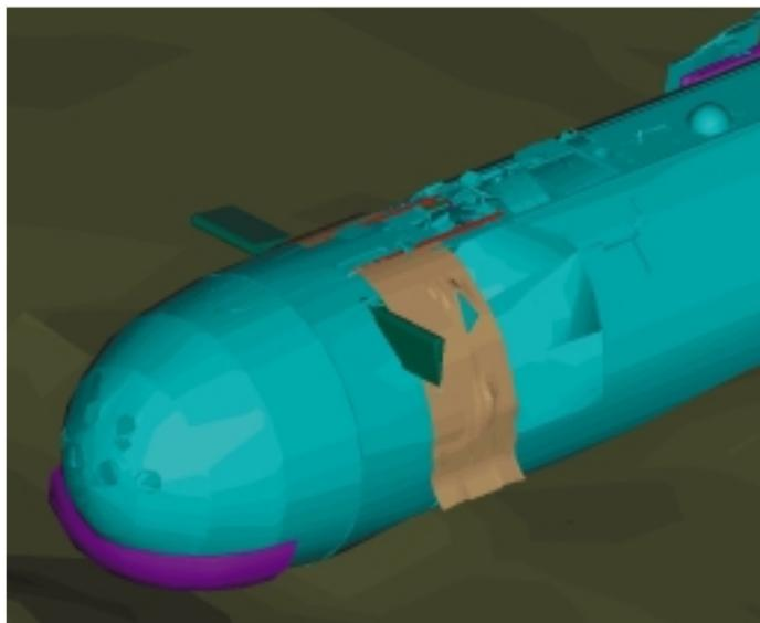
Рис. 6. Компьютерный проект укрытия АПЛ «Комсомолец»
