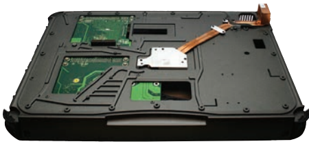
Рис. 5. Расширение PCI x2 для ноутбука X500
