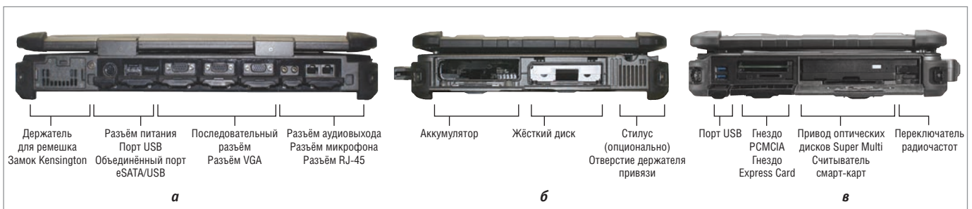
Рис. 3. Расположение портов на задней (а), правой (б) и левой (в) панелях ноутбука
