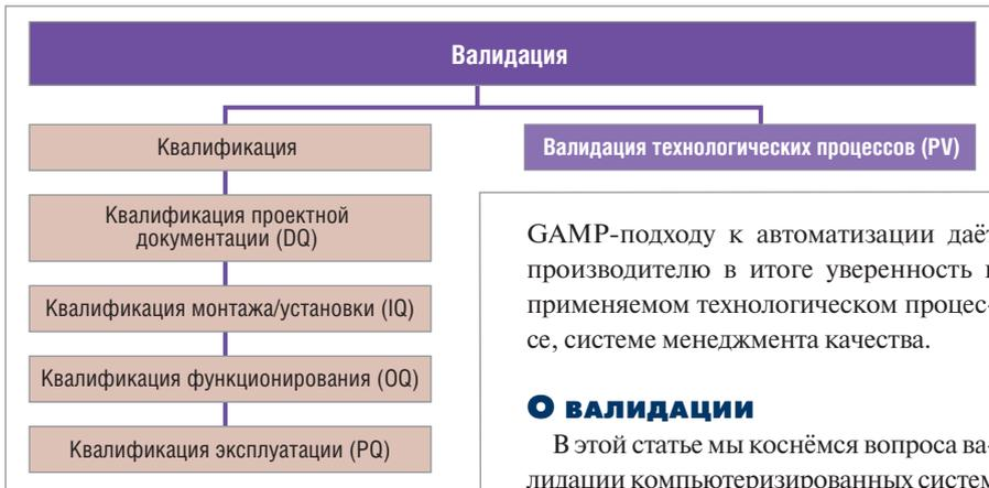
Рис. 2. Классическая схема процесса валидации
