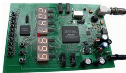
Рис. 5. Отладочная плата генератора с устройством набора частоты
