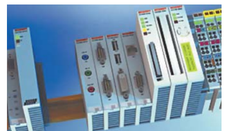
Рис. 7. Промышленные PC-совместимые контроллеры фирмы Beckhoff серии CX1000
